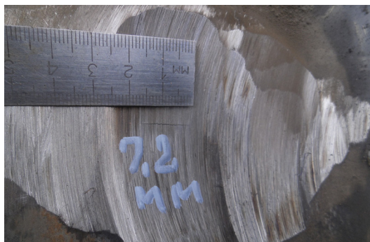
Рис. 1. Подтверждение на кольцевом сварном шве трещин типа Еб, выявленных прибором поперечного намагничивания ДМТП
