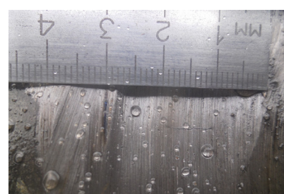
Глубина 4 мм, длина трещины 8 мм
